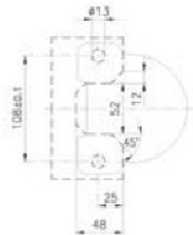
Dimensioni della base di montaggio Caliper base dimensions
